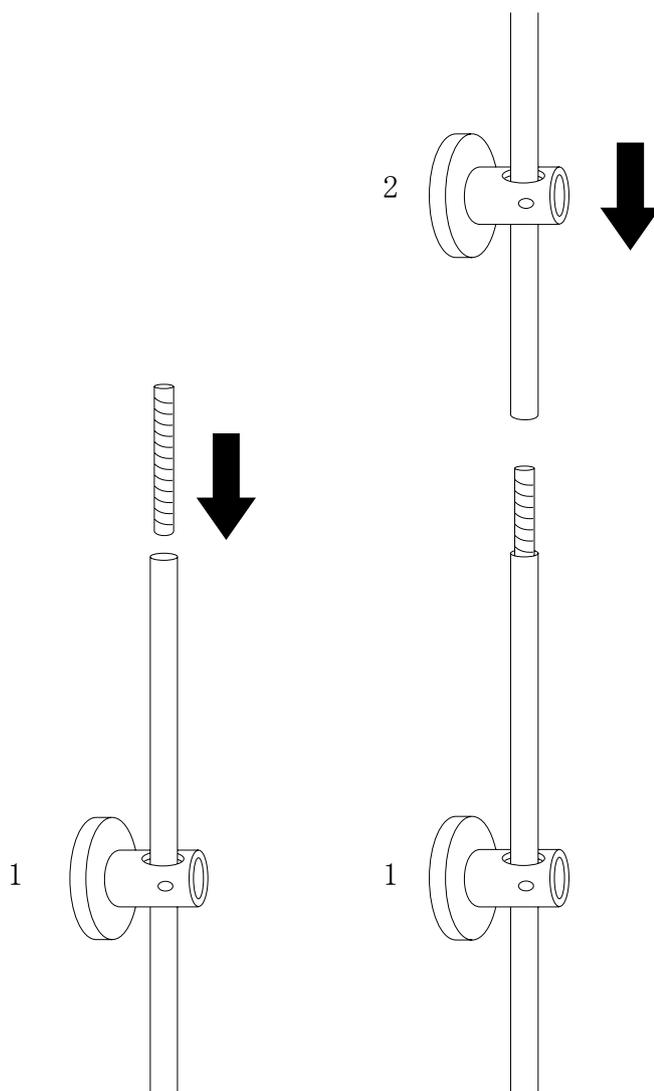
\*下の図の通り、向きを確認して正しい方向にパネルを設置して下さい。
