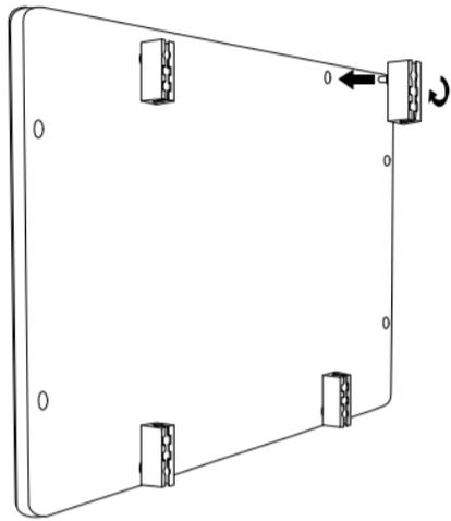
クリップの裏面がネジになっているので手で回してつける
