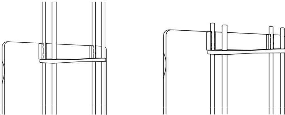
\*大きいパネルを設置する際は「メタルクリップ」を使用します。下の取付方法をご確認ください。
